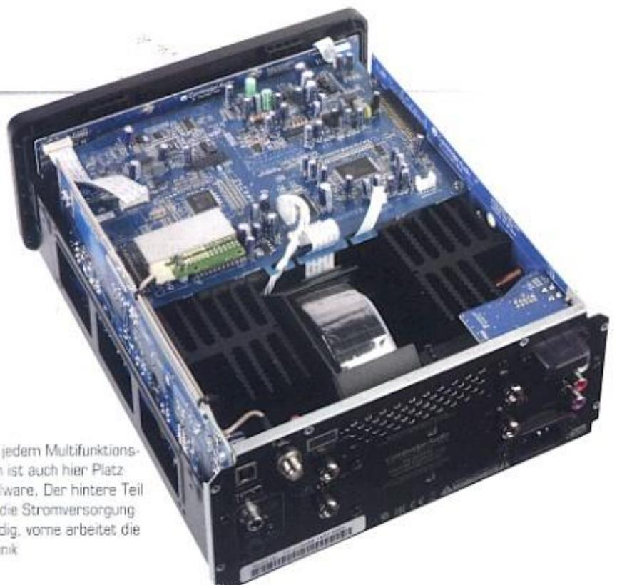
Wie in jedem Multifunktionssystem ist auch hier Platz Mangelware. Der hintere Teil ist für die Stromversorgung zuständig, vorne arbeitet die Elektronik
